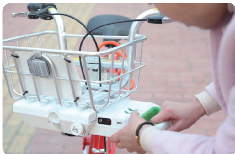
【かごの下にバッテリーを差し込めば、電動補助付き自転車に】
